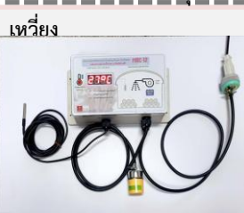
กล่องควบคุมโรงเพาะเห็ดอัตโนมัติ
